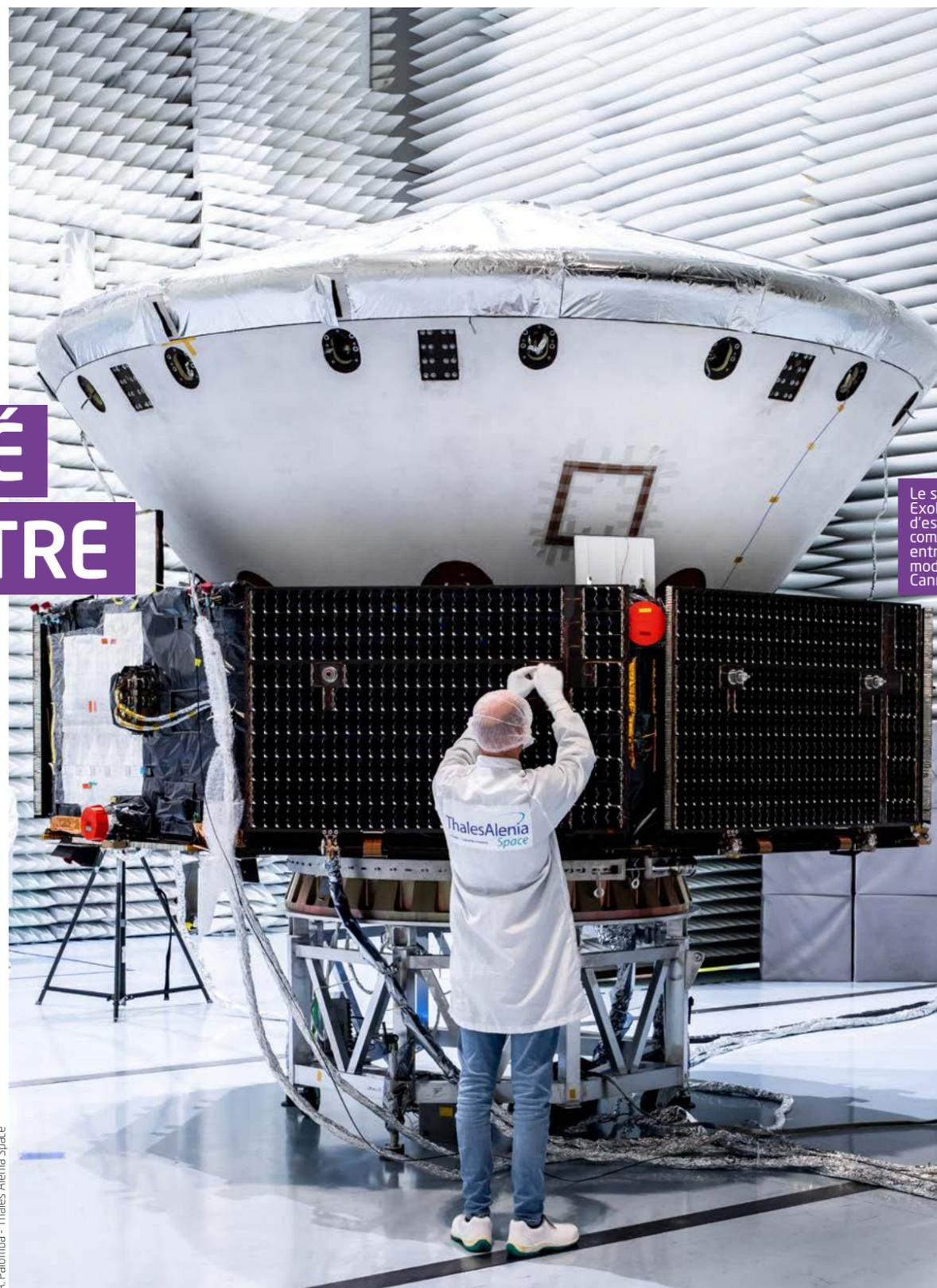
Le sonde ExoMars, lors d'essais de compatibilité entre ses trois modules à Cannes
