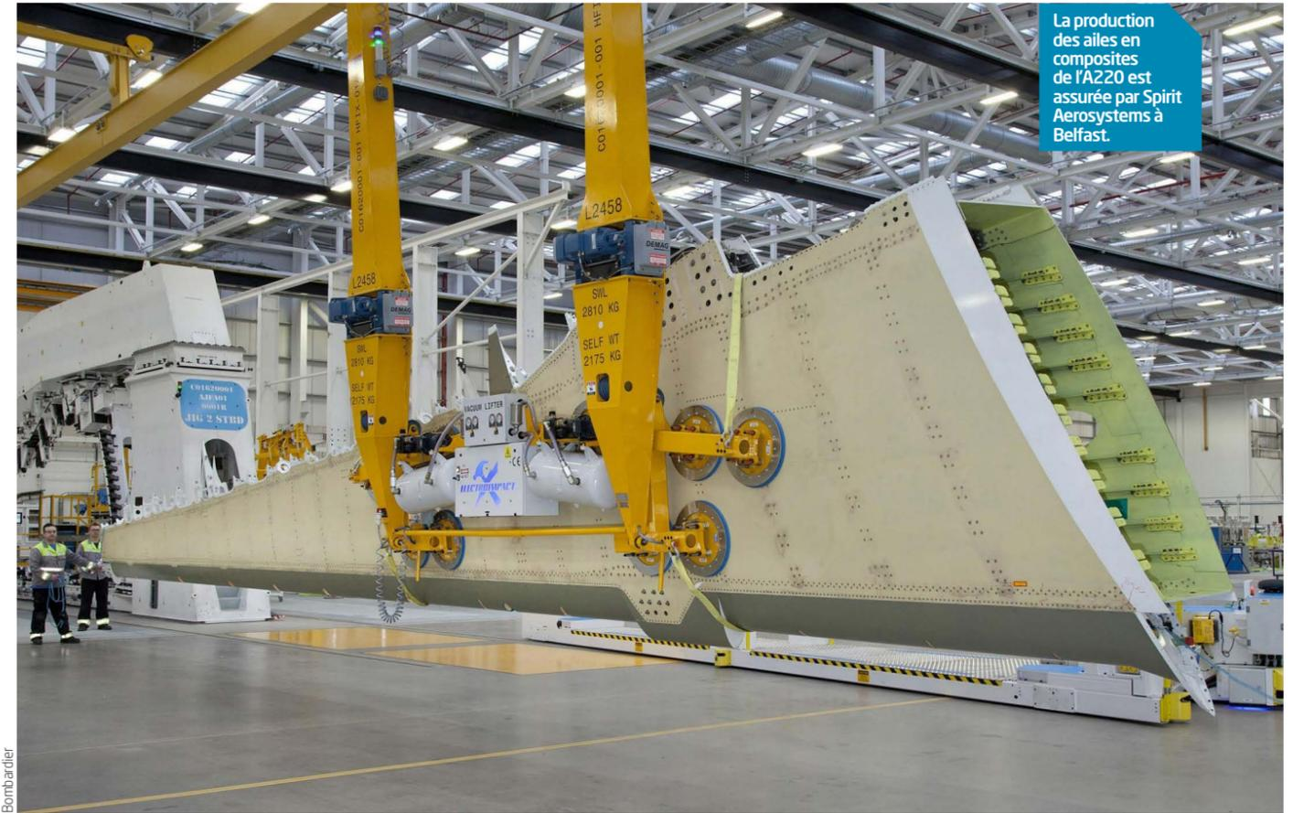
La production des ailes en composites de l'A220 est assurée par Spirit Aerosystems à Belfast.
