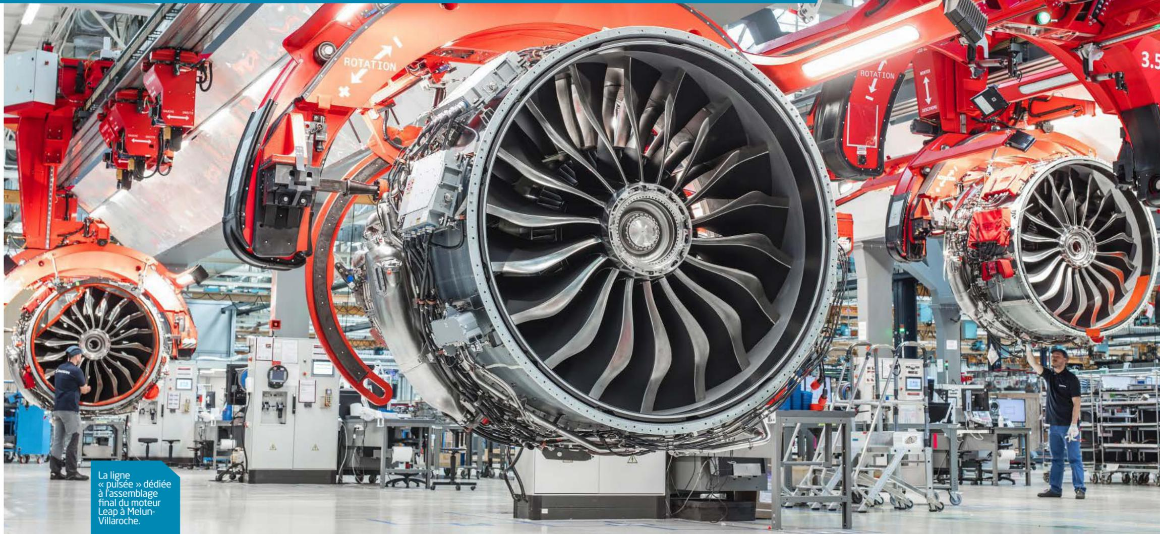
La ligne « pulsée » dédiée à l'assemblage final du moteur Leap à Melun-Villaroche.
